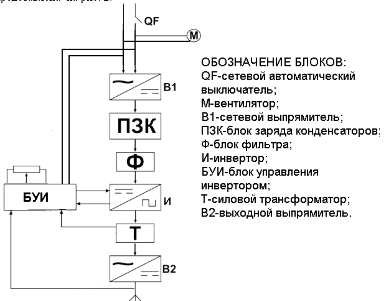
Рис.2 Обобщенная структурная схема выпрямителя.
