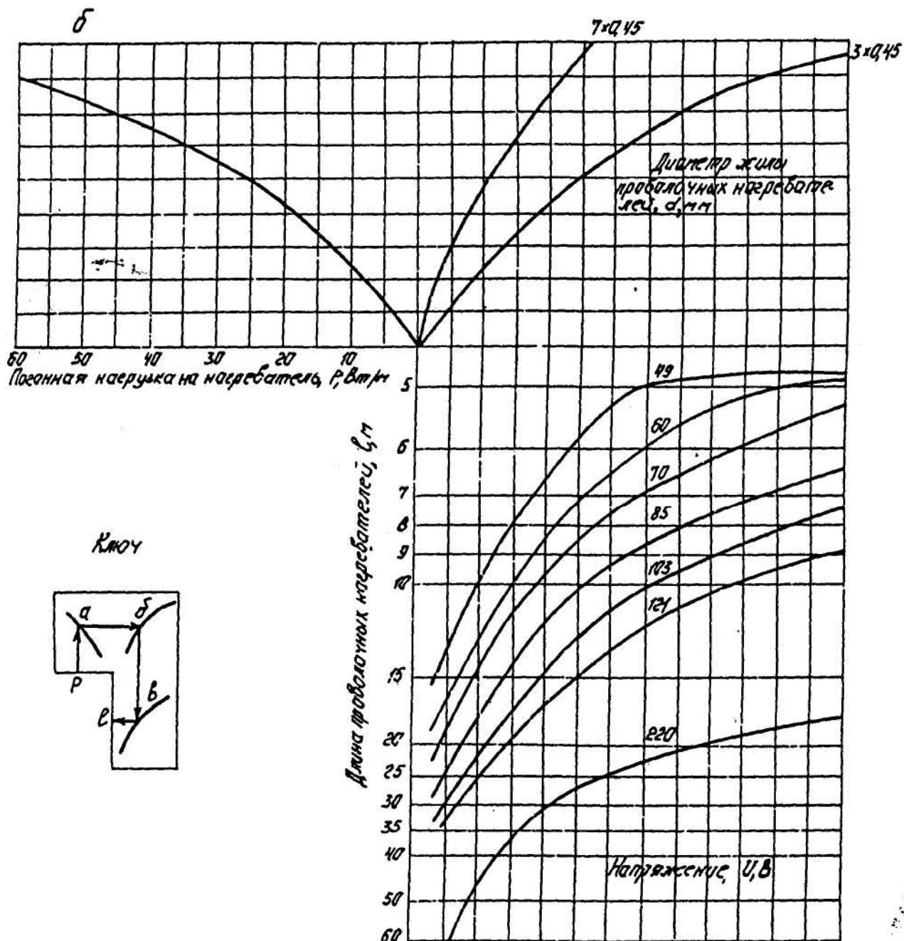
Рис. 9. Номограмма для определения длины проволочных нагревателей с никромовой жилой
