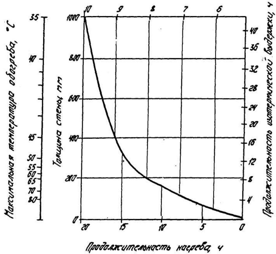
Рис.5. Номограмма для определения продолжительности термообработки монолитных стен и перекрытий
