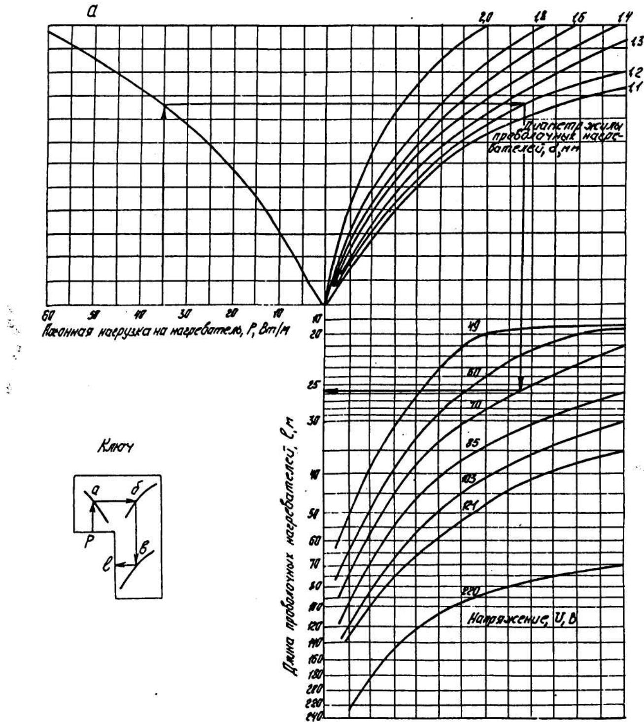
Рис. 8. Номограмма для определения длины проволочных нагревателей со стальной оцинкованной жилой
